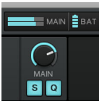
Ilust. 5.34 – Los botones S y Q permiten activar o desactivar los modos de adhesión y cuantificación respectivamente.
